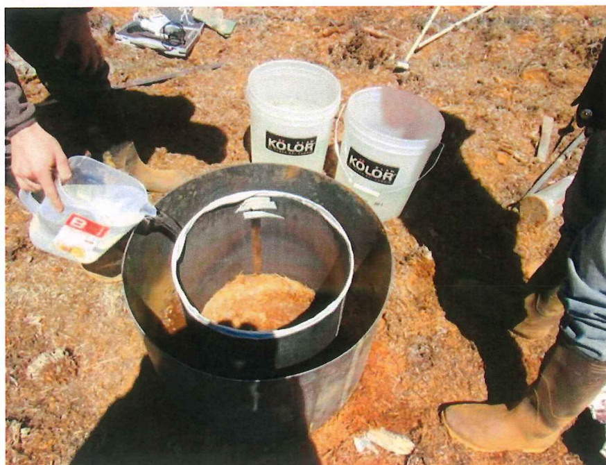
Foto N° 15: Preparación del espacio entre los anillos para la medición de la infiltración.
