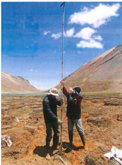
Foto N° 18: Perforación de un pozo con ayuda de un barreno ruso. Foto: Jan R. Baiker.
