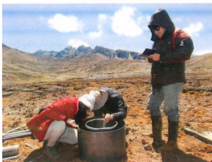
Foto N° 16: Último paso de preparación de los anillos, antes de iniciar la medición de la infiltración. Foto: Susan Manrique.
