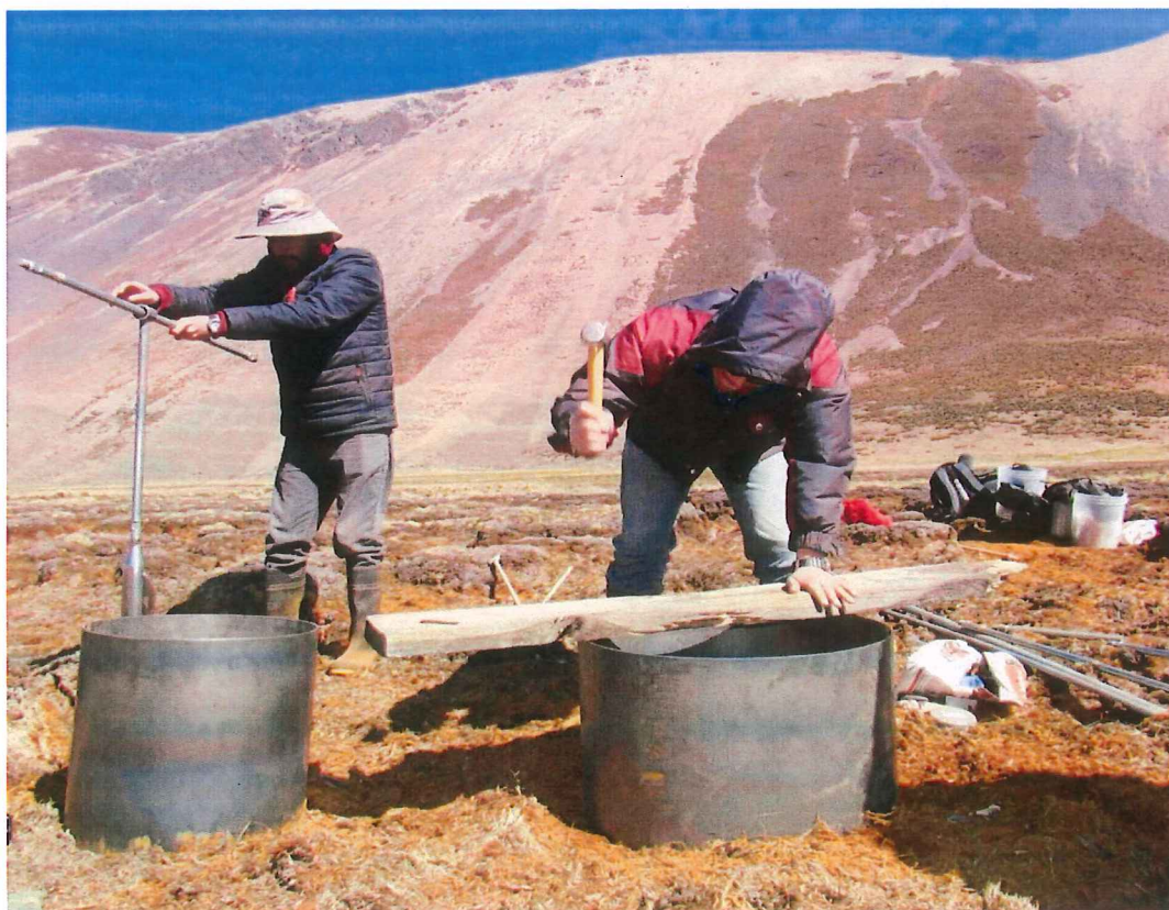
Foto N° 02: Dos de los instrumentos usados para la evaluación del suelo; a la izquierda: Barreno ruso ( Russian Peat Corer ) para sacar núcleos intactos con turba; a la derecha: doble anillos para el experimento de infiltración.
